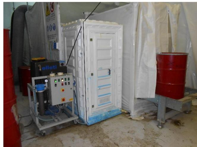
**Attività di riconfezionamento dei rifiuti contenenti amianto in fusti petroliferi da 220 l, da trasferire presso NUCLECO per il trattamento di supercompattazione**
